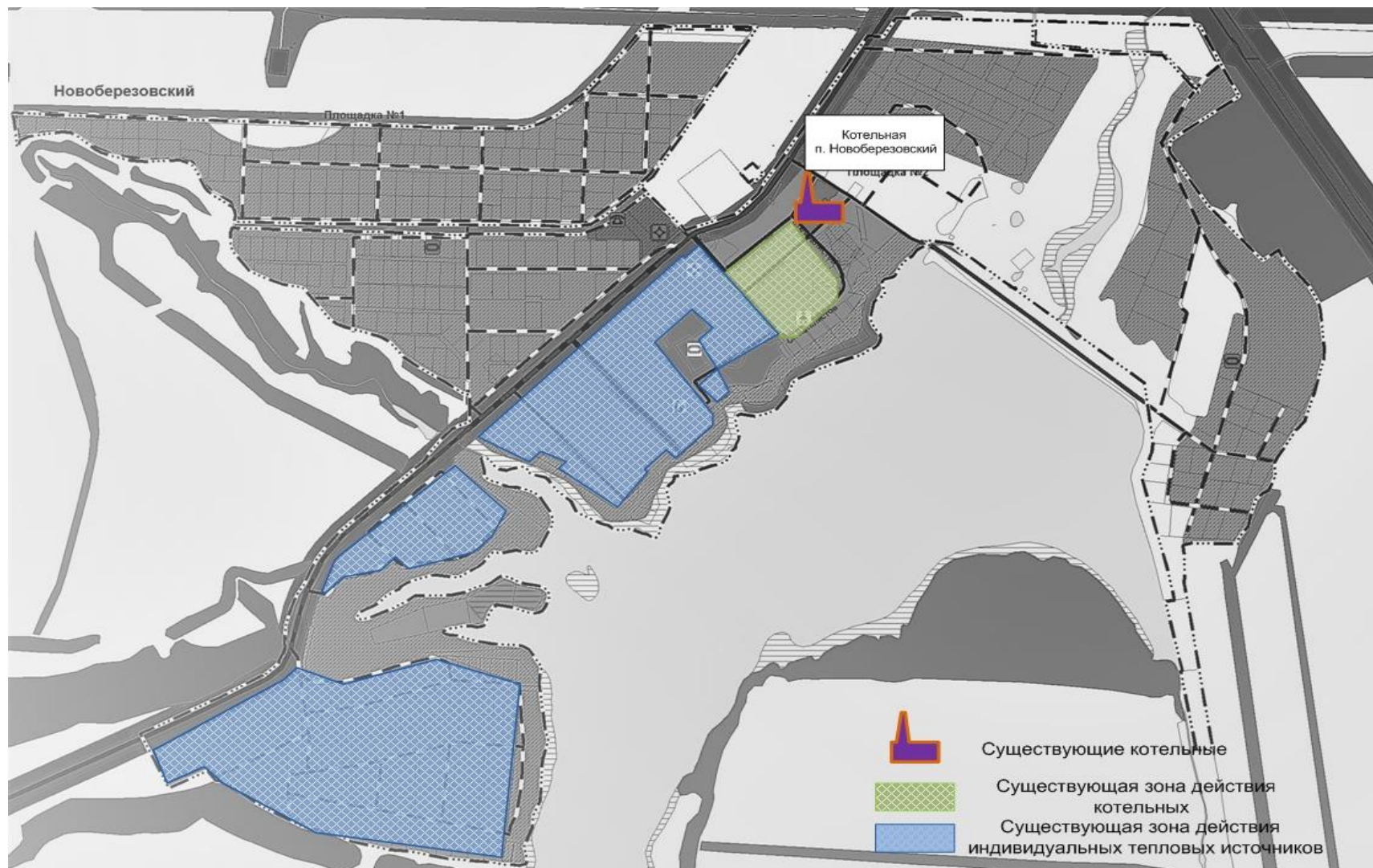
Рисунок 15 - Существующая зона отопления от котельной и индивидуальных источников п. Новоберезовский.
