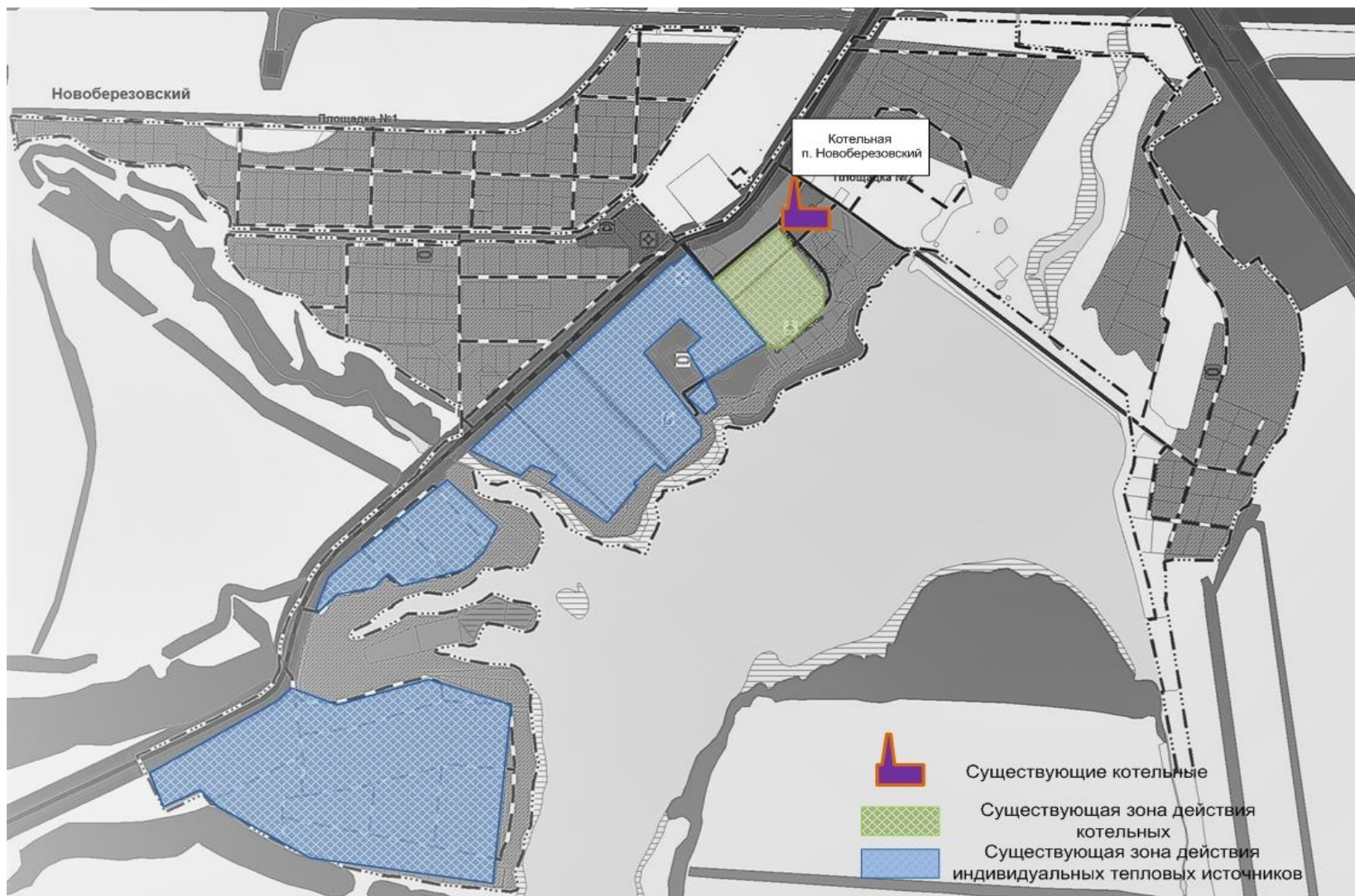
Рисунок 18 - Существующая зона отопления от котельной и индивидуальных источников п. Новоберезовский.
