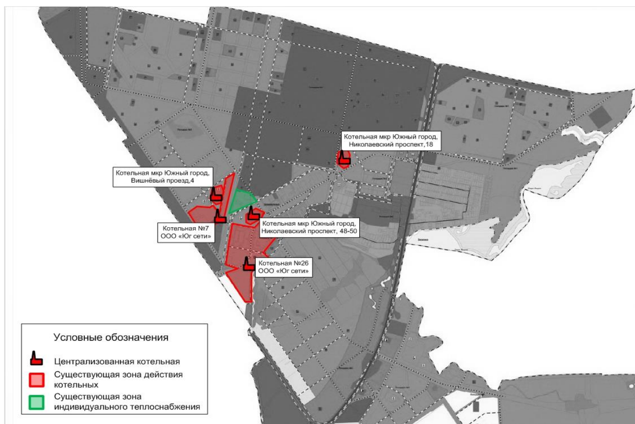
Рисунок 1.12.6.5 – Централизованные источники тепловой энергии с.п. Лопатино, п. Придорожный, мкр. Южный город
